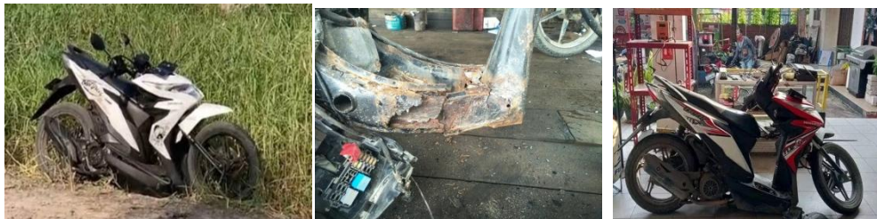
Gambar 2. Rangka ESAF Patah
