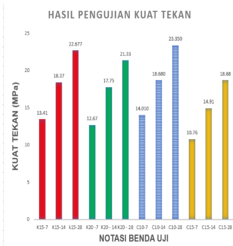
Gambar 3. Grafik Hasil Pengujian Kuat Tekan
