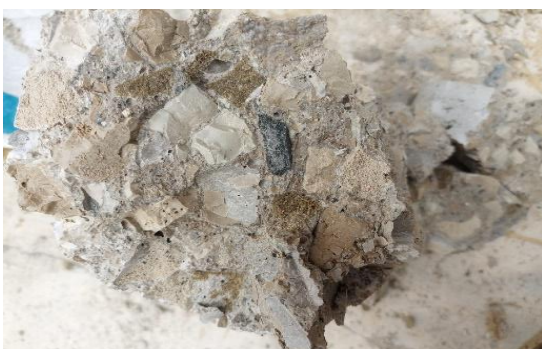
Gambar 5. Pola Keruntuhan Beton Berbahan Plastik
