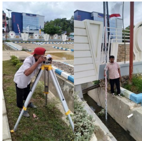
Gambar 4. Dokumentasi pengukuran elevasi eksisting
