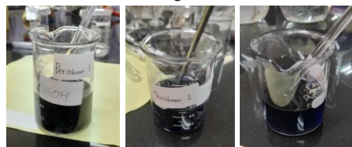
Gambar 2. Perubahan Warna akibat Reaksi K 2 S 2 O 8 dengan KI
