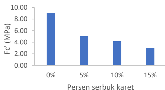
Gambar 6. Hasil Uji Kuat Tekan Beton
