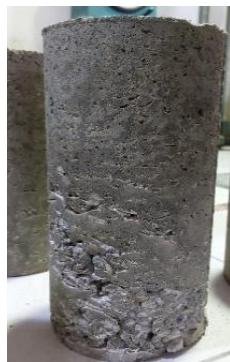
Gambar 10. Benda Uji 15% Camuran Serbuk Karet Ban Bekas
