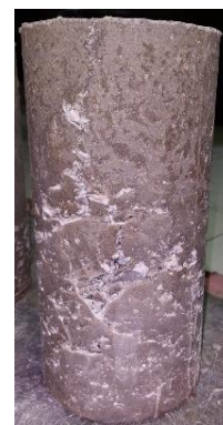
Gambar 8. Benda Uji 5% Camuran Serbuk Karet Ban Bekas
