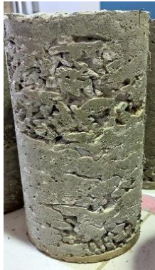
Gambar 9. Benda Uji 10% Camuran Serbuk Karet Ban Bekas
