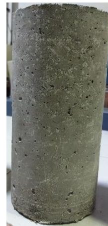
Gambar 7. Benda Uji 0% Campuran Serbuk Karet Ban Bekas
