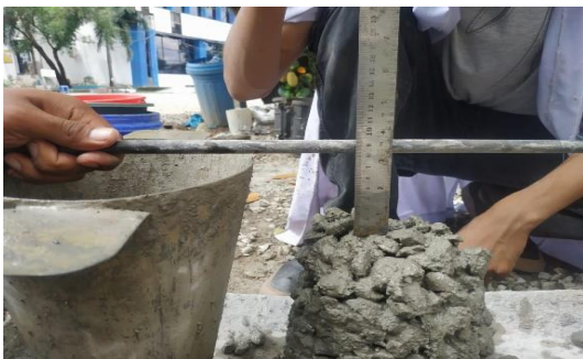
Gambar 4. Pengujian Slump Test
