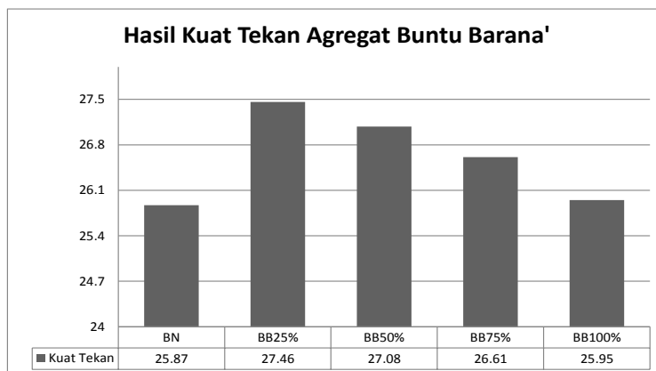
Gambar 1. Hasil Pengujian Kuat Tekan Beton Variasi
