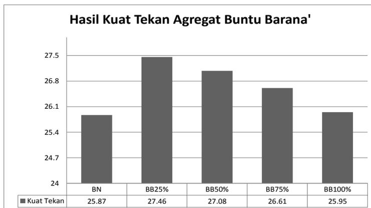
**Gambar 1.** Hasil Pengujian Kuat Tekan Beton Variasi
