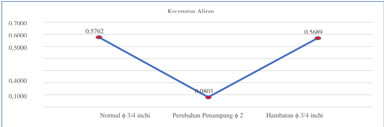
Gambar 2. Kecepatan aliran pada pipa normal, perubahan penampang, dan hambatan.
