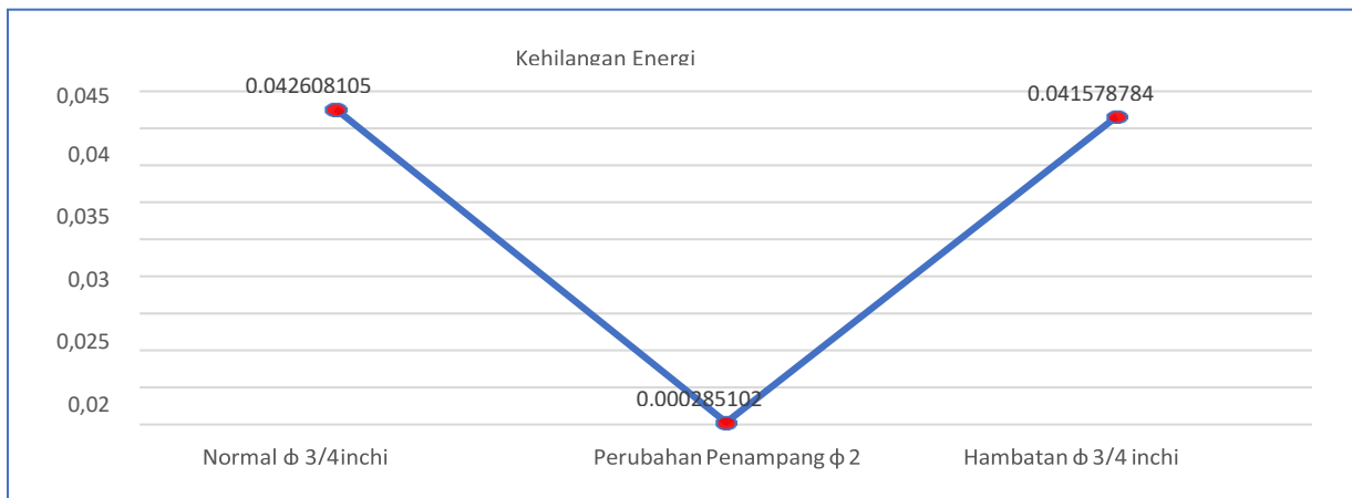
Gambar 4. Kehilangan energi pada pipa normal, perubahan penampang, dan hambatan
