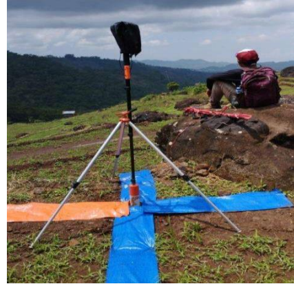
Gambar 10. Proses Pengukuran GCP ICP
