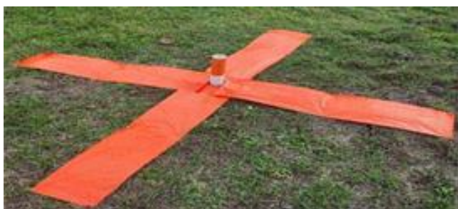
Gambar 3. Pemasangan Premark Pada Lokasi GCP
