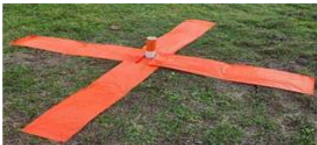
Gambar 3. Pemasangan Premark Pada Lokasi GCP
