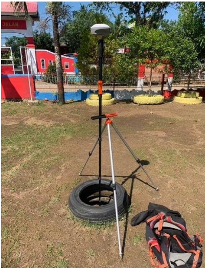
Gambar 8. Pengukuran GNSS Statik JKHN TTG.0168
